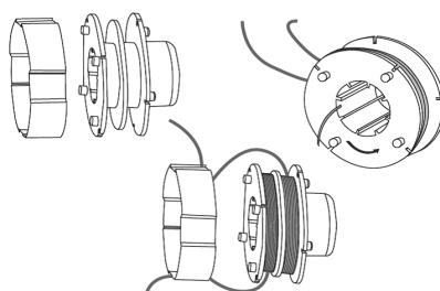
Fig. 7 – Montagem do fio de nylon no carretel
