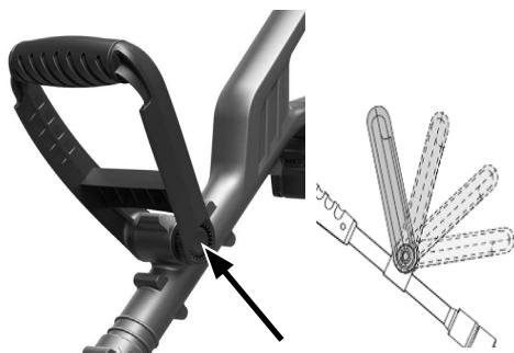
Fig. 2 – Colocar e ajustar o punho inferior
