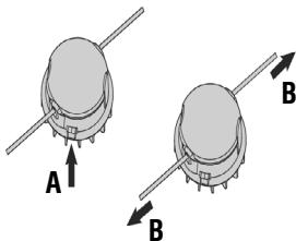
Fig. 4 – Alimentación automática del hilo de nylon
