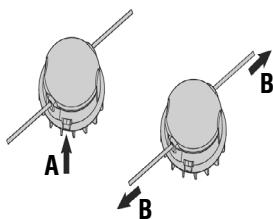
Fig. 4 – Alimentação manual do fio de nylon
