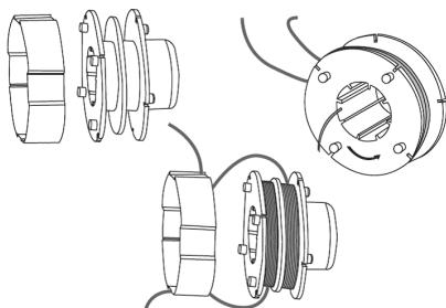
Fig. 7 – Montaje del hilo de nylon en el carrete
