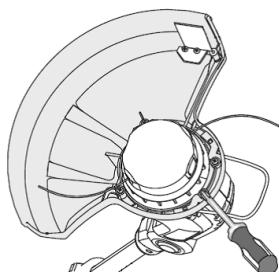
Fig. 3 – Colocar a proteção de segurança do aparador
